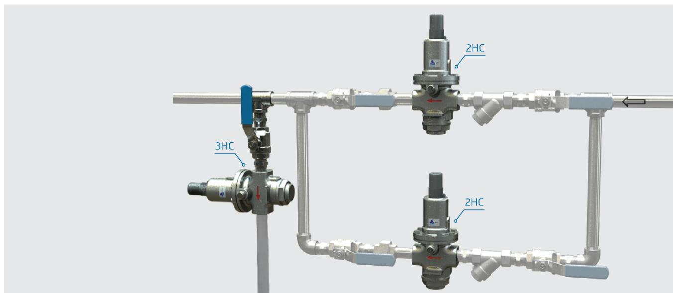
**Sistema redutor de pressão** com redundância, com duas válvulas redutoras de pressão de ação direta BERMAD DPRV-2HC em paralelo e uma válvula de alívio de pressão de ação direta BERMAD DPRV-3HC.
