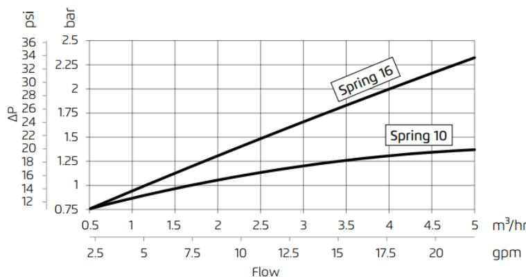
Reducción de la presión aguas abajo a medida que aumenta el caudal después de calibrar una DPRV a caudal cero.
