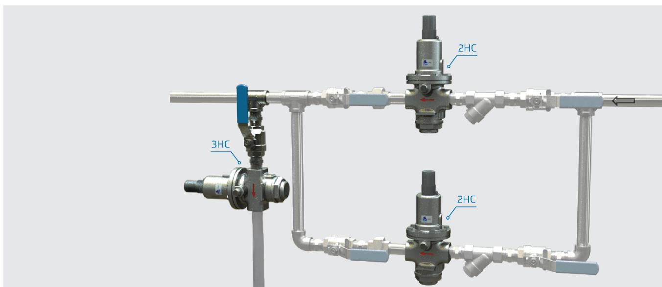
**Sistema de reducción de presión** con redundancia, con dos válvulas reductoras de presión directas BERMAD DPRV-2HC en paralelo y una válvula de alivio de presión directa BERMAD DPRV-3HC.
