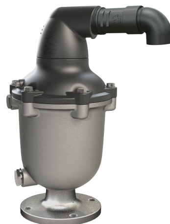
C50-G-Flangiato con protezione contro le sovrappressioni e gomito a 90 gradi
