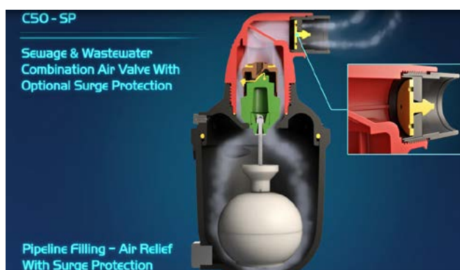
Imagem 3.6 - C50, Alívio de ar com Proteção de Surto (SP) baseado em Selo
