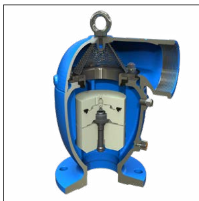
Imagem 2.4 - Válvulas de combinação de ar com um recurso adicional de disco de Proteção de Surto (SP)
