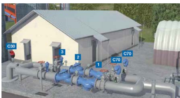
Imagem 4.3 - Sistema de Redução de Pressão com redundância total
