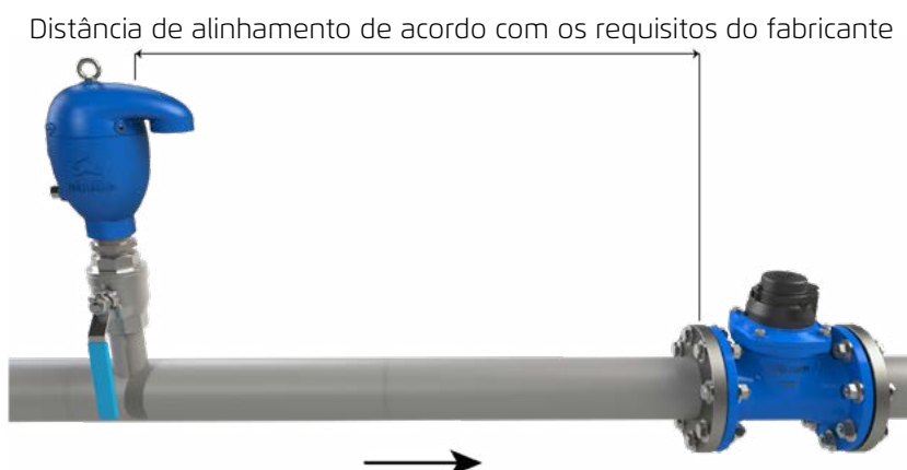
Imagem 5.8 – A montante dos hidrômetros
