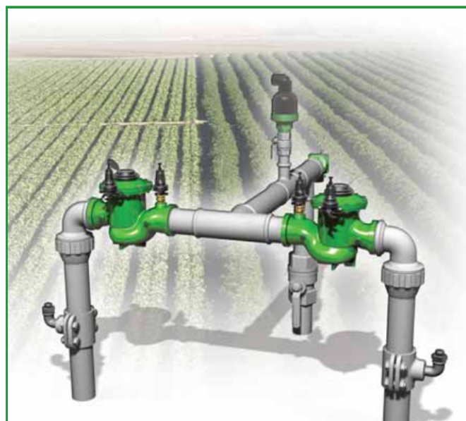
[1] דגם ברמד IR-972-M0-2W-KVZ מגביל דרישה עודפת, שולט על קווים צדדיים ומילוי קו הפצה תוך הקטנת לחץ, ומודד ספיקה.
