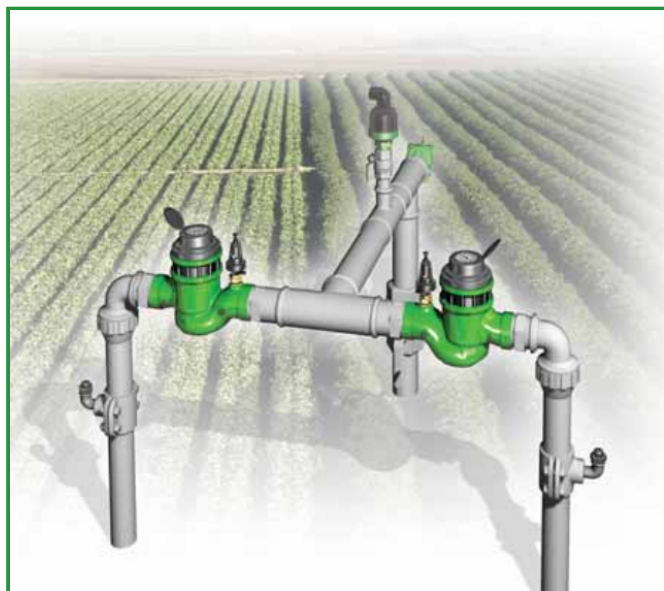
[1] O Modelo BERMAD IR-970-M0-2W-KVZ limita a taxa de enchimento e a demanda excessiva, e mede o fluxo.
