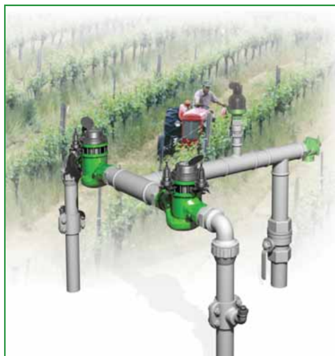
[1] דגם ברמד IR-923-ME-3W-KXZ שומר על לחץ מערכת האספקה, מונע ריקון המערכת, מקטין לחץ מורד, מגן על קווים וצינורות צדדיים, ומודד ספיקה.
