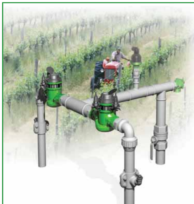
[1] BERMAD IR-923-ME-3W-KXZ 减压持压水表阀可维持供水系统压力，防止系统排空，降低下游压力，保护主管和支管，并测量流量。
