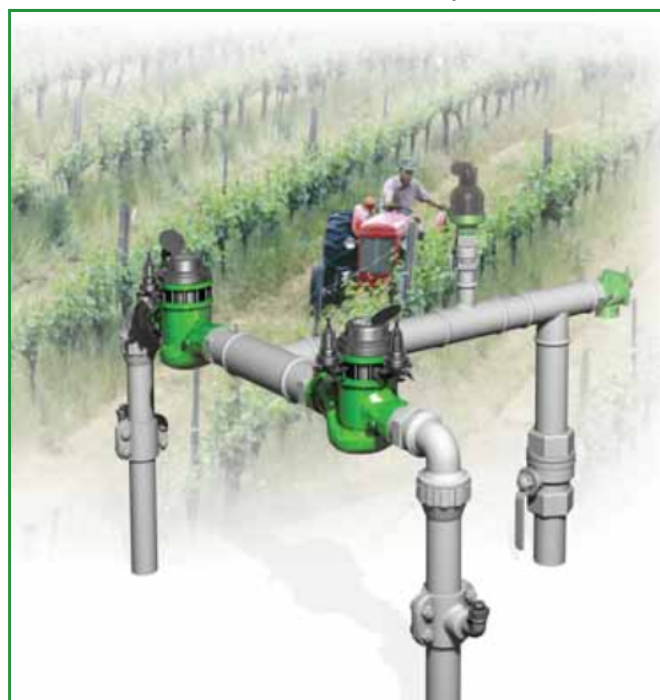
[1] דגם ברמד IR-923-M0-3W-KXZ שומר על לחץ מערכת האספקה, מונע ריקון המערכת, מקטין לחץ מורד, מגן על קווים וצינורות צדדיים, ומודד ספיקה.
