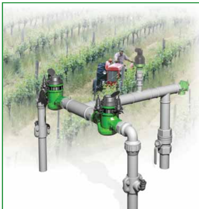
[1] BERMAD IR-923-M0-3W-KXZ 型减压持压水表阀可维持供水系统压力，防止系统排空，降低下游压力，保护主管和支管，并测量流量。
