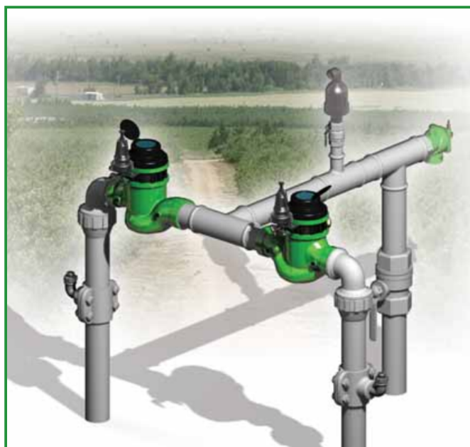
[1] Le modèle BERMAD IR-920-ME-3W-KXZ établit une zone de pression réduite, protégeant les latéraux et la ligne de distribution.
