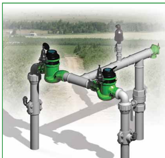
[1] דגם ברמד IR-920-M0-3W-KXZ יוצר אזור לחץ מוקטן, ומגן על קווים צדדיים וקו ההפצה.
