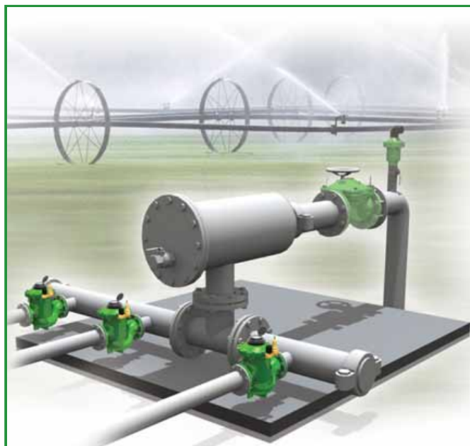
[1] BERMAD 型号 IR-920-M0-55-2W-R 减压水表阀在接收到电信号时开启，建立减压区并测量流量。
