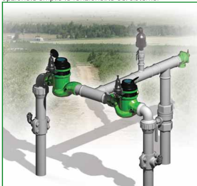
[1] Il modello BERMAD IR-920-M0-50-3W-KXZ si apre su comando di caduta di pressione, crea una zona a pressione ridotta e misura il flusso.
