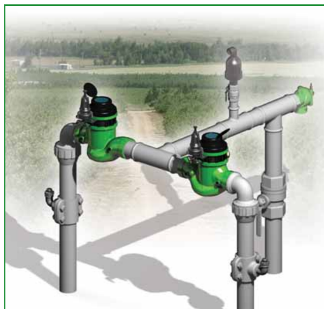
[1] דגם ברמד IR-920-M0-50-3W-KXZ נפתח בפקודת ירידת לחץ, יוצר תחום לחץ מוקטן ומודד ספיקה.
