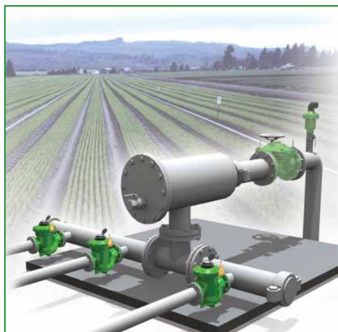
[1] דגם ברמד IR-920-M0-50-2W-R נפתח בעת ירידת לחץ פיקוד, יוצר אזורי לחץ מוקטן ומוודד את הספיקה.
