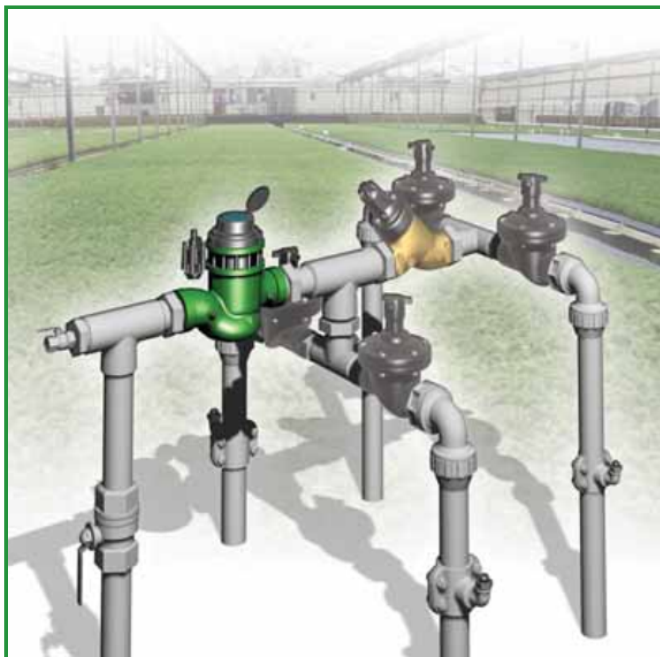
[1] BERMAD Model IR-900-M0-54-3W-KX opent bij stijgende stuurdruk en meet het debiet.
