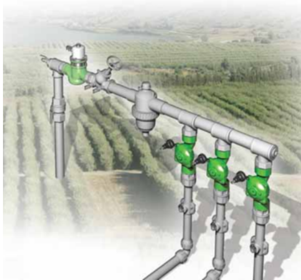
[1] BERMAD Model IR-430-50-KXZ opent bij een dalende stuurdruk, handhaaft de aanvoerdruk van het systeem en regelt het vullen van de lateralen en de distributieleiding.
