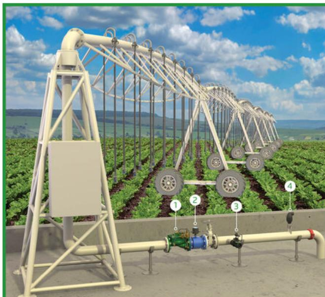
[1] Le modèle BERMAD IR-420-55-3W-RX s'ouvre en réponse à un signal électrique et établit une zone de pression réduite protégeant les latéraux et la ligne de distribution.
