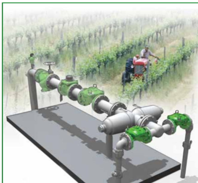
[1] O Modelo BERMAD IR-405-RZ abre mediante comando manual local.
