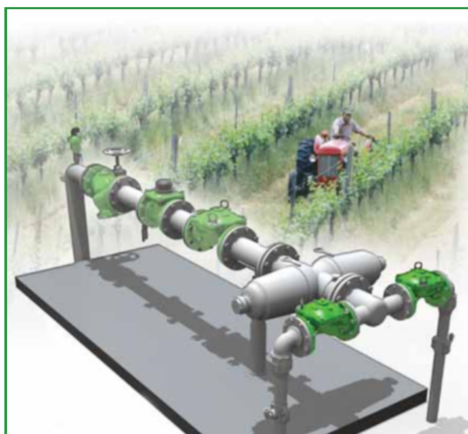
[1] Le modèle BERMAD IR-405-RZ s'ouvre sur commande manuelle locale.
