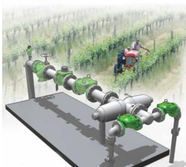
[1] BERMAD IR-405-RZ 型号阀门可通过本地手动指令开启。
