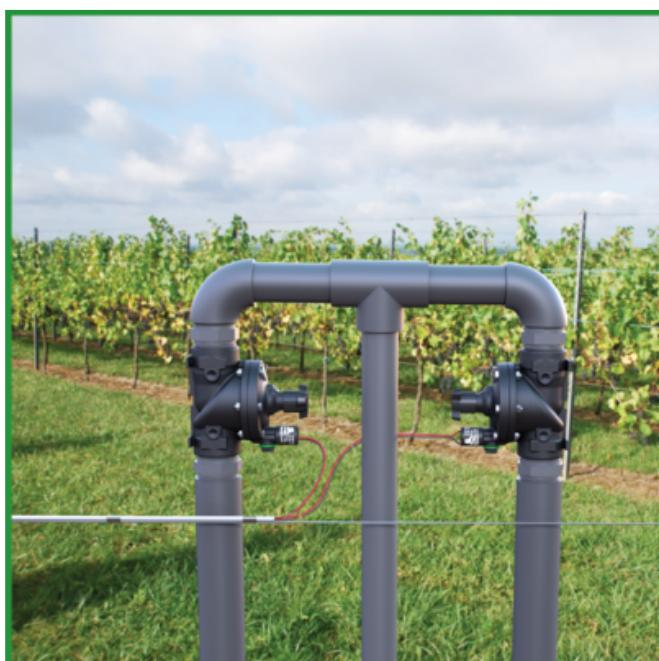
[1] El modelo IR-21T de BERMAD se abre y cierra herméticamente en respuesta a una señal eléctrica, lo que hace que el solenoide abra o cierre el circuito hidráulico interno de la válvula.
