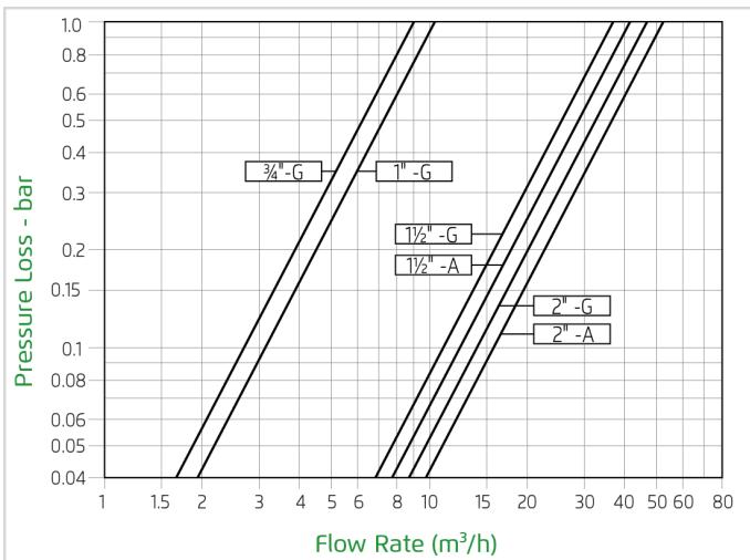
Circuito a 2 vie "Perdita di Carico Aggiunta" (per "V" inferiore a 2 m/s): 0,3 bar
