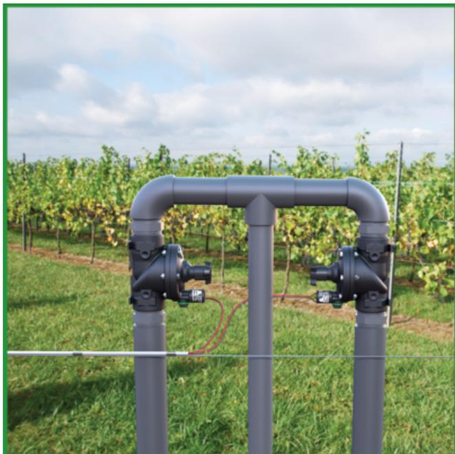
[1] La valvola BERMAD modello IR-21T si apre e si chiude a tenuta stagna in risposta a un segnale elettrico, che aziona l'apertura o la chiusura del circuito idraulico interno della valvola tram
