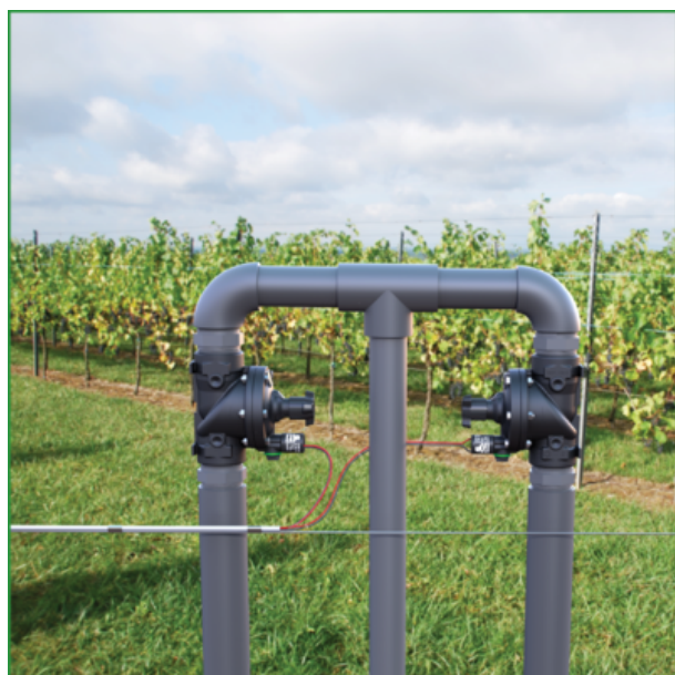
[1] BERMAD IR-21T 型号根据电信号的响应实现严密开启和关闭，该信号使电磁阀打开或关闭阀门的内部液压回路。
