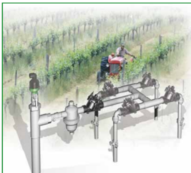
[1] Il modello BERMAD IR-172-55-Db si apre in risposta al segnale elettrico, protegge il sistema di alimentazione da un flusso eccessivo, limita il riempimento della linea laterale e di distribu
