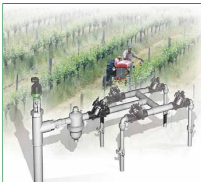
[1] דגם BERMAD IR-172-55-Db נפתח בתגובה לאות חשמלי, מגן על מערכת האספקה מספיקה עודפת, מגביל מילוי קווים צדדיים וקווי הפצה, ומקטין את לחץ העבודה שלהם.
