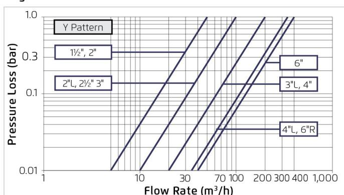
Circuito a 2 vie "Perdita di Carico Aggiunta" (per "V" inferiore a 2 m/s): 0,3 bar
