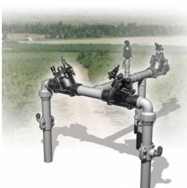
[1] BERMAD Model IR-120-55-b opent als reactie op een elektrisch signaal en creëert een drukgereduceerde zone die de lateralen en de distributieleiding beschermt.
