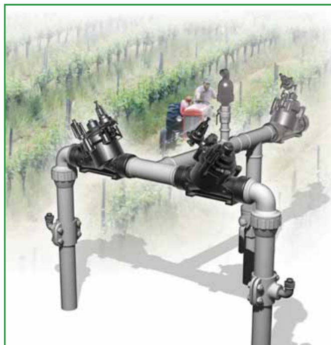
[1] דגם BERMAD IR-120-54-b נפתח בעת פקודת עליית לחץ, ויוצר אזור לחץ מוקטן המגן על קווים צדדיים וקו ההפצה.
