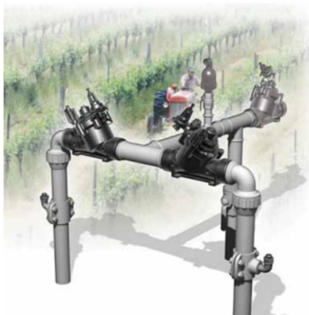
[1] BERMAD 型号 IR-120-54-b 在接收到压力上升指令时开启，并建立减压区，以保护支管和配水管线。
