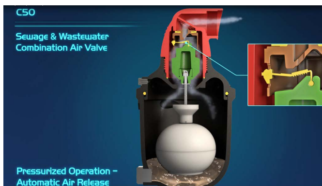
איור 2.3 שחרור אוויר אוטומטי בשסתום C50 הקש על הלינק לצפייה בעקרונות הפעולה של שסתום C50
