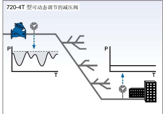
720-4T 型动态减压阀配备减压控制器，可根据短时用水量或系统最不利点所需最低压力不断调节设置值。结果显示，使用该款阀门后，管网平均压力大幅降低，系统漏水和爆管现象减少，既节能又可降低维护费用。阴影部分表示时间与压力关系图，平均压力降低后，漏水现象减少。
