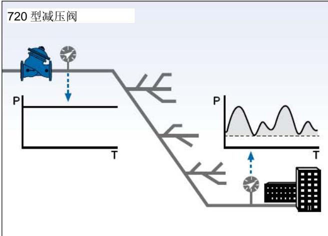
常规减压阀进行设置后可保持稳定的阀后低压，确保系统最不利点在用水高峰时（此时沿程水头损失最大）有足够系统压力。阴影部分表示时间与压力关系图，其中压力高于要求水平。
