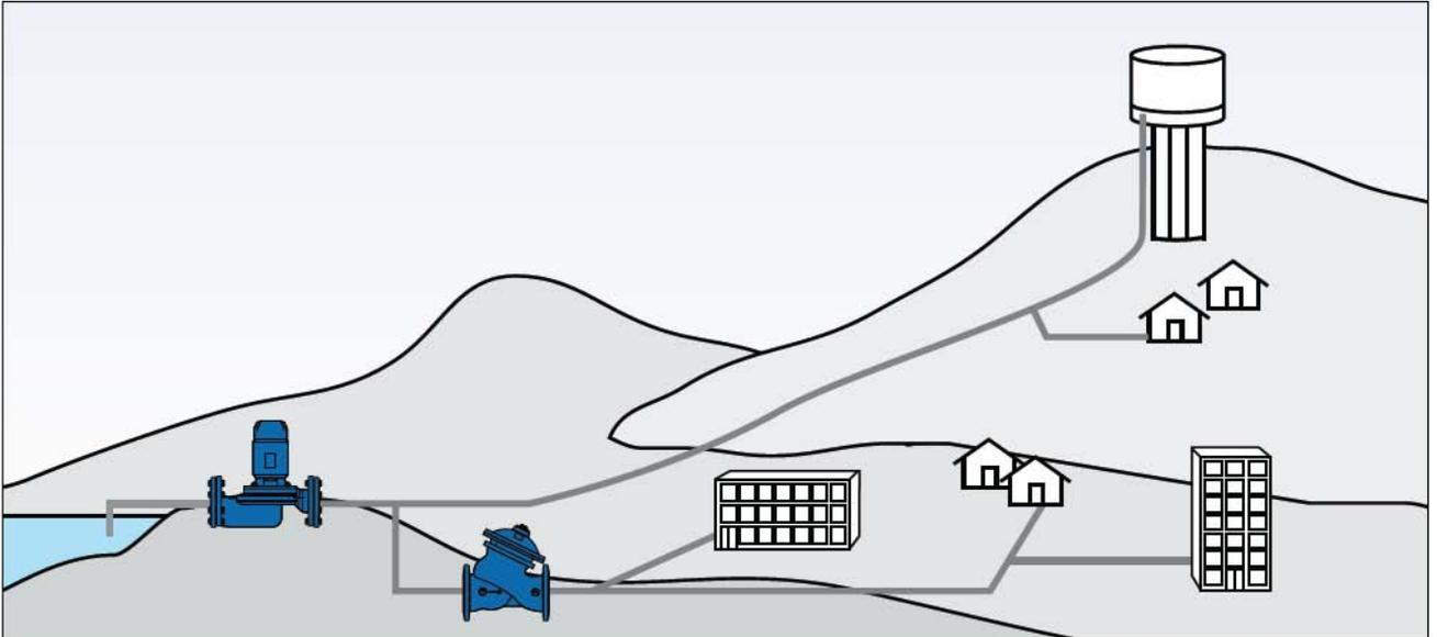
水泵同时向管网和蓄水池供水。系统压力远远超过居民区所需的压力，因此需要配备减压系统。
